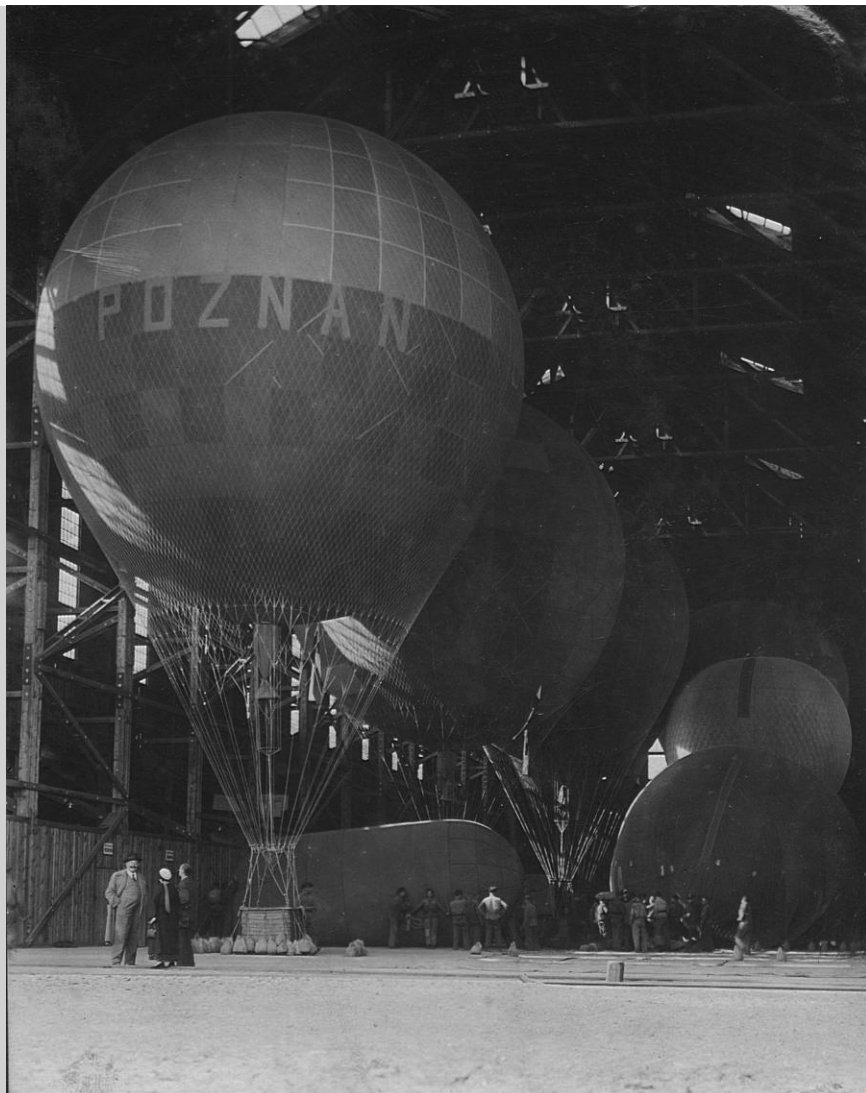
VI Zawody Balonowe w Legionowie 25 września 1933 r. Wnętrze hangaru 2. Batalionu Balonowego z oczekującymi na start balonami kulistymi. Uwagę zwraca leżący poziomo gazochron – przegumowany zbiornik o pojemności 100 m 3 , liczący 9,3 m długości i służący do transportowania wodoru.
